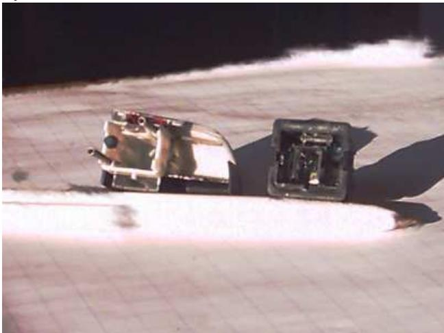
Bringt man die Federn und den Gummistopfen an dem aus dem Armaturenbrett ausgebauten Blinddeckel an und clipst diesen auf das aus der Sitzkonsole ausgebaut Original-Schalterunterteil, so stellt man – oh Wunder!!! – fest, dass man einen funktionsfähigen Schalter hat, der in die Öffnungen am Armaturenbrett passt und perfekt funktioniert.
